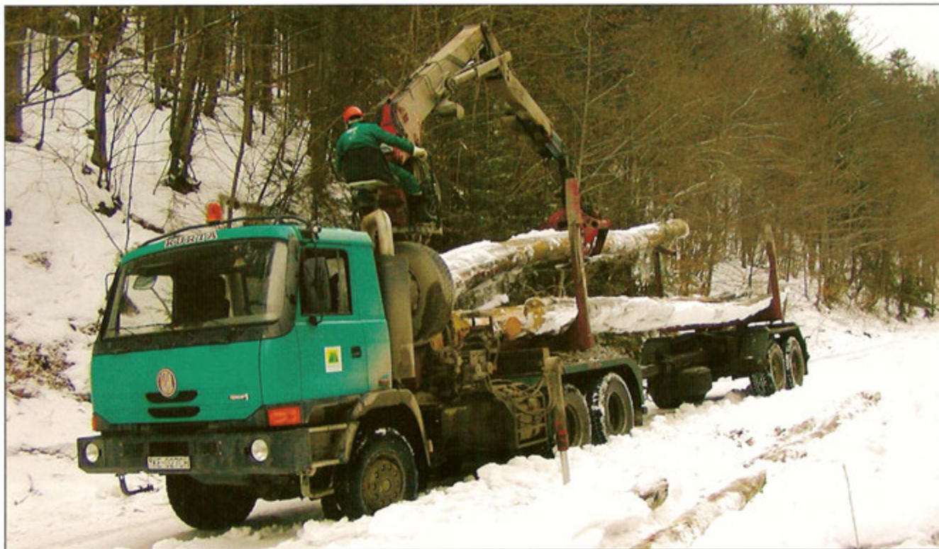
Odvoz a nakladanie dreva na odvoznú súpravu Tatra 815 s hydraulickou rukou
