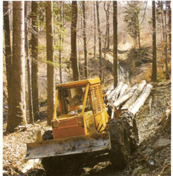
Dominantným približovacím prostriedkom je špeciálny lesný kolesový traktor
